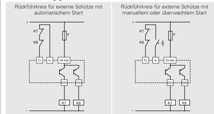
Für den ordnungsgemäßen Betrieb müssen Module oder eine SPS, die möglicherweise an die elektronischen OSx Sicherheits-Ausgänge angeschlossen sind, zyklische
