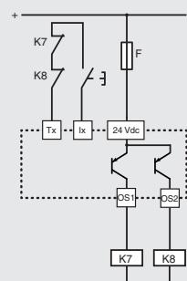
Per un corretto funzionamento eventuali moduli o PLC connessi alle uscite sicure elettroniche OSx devono tollerare i test ciclici di disattivazione che vengono effettuati sulle medesime.
