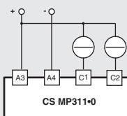
Esquema con sensores de 3 hilos
