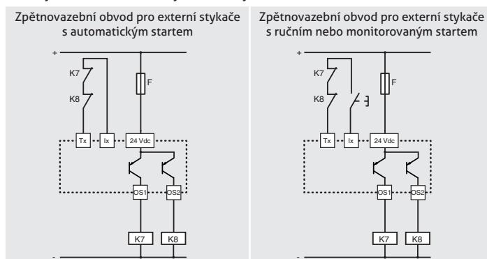
Aby správně fungovaly, musí všechny moduly nebo PLC připojené k bezpečnostním elektronickým výstupům OSx odolat cyklickým deaktivacím testům prováděným na modulech nebo PLC.
