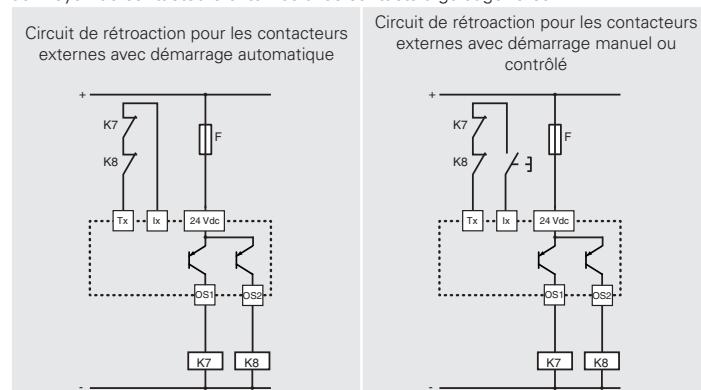
Pour un fonctionnement correct, tout module ou automate connecté aux sorties électriques de sécurité OSx doit tolérer les tests cycliques de désactivation qui y sont effectués.
